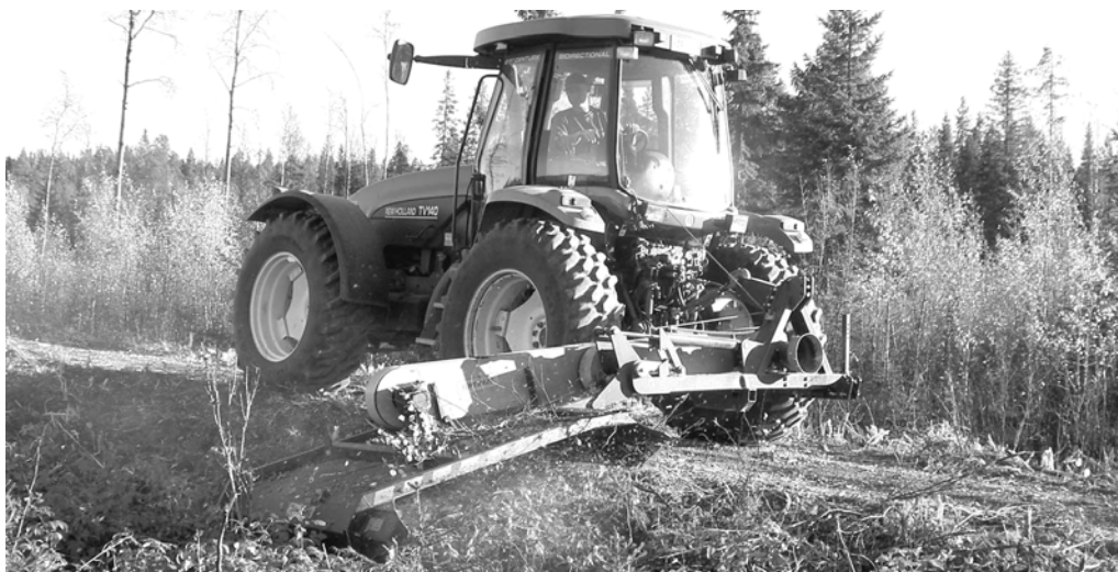
M160, monterad bak på en backande traktor med omvänd förarplats
